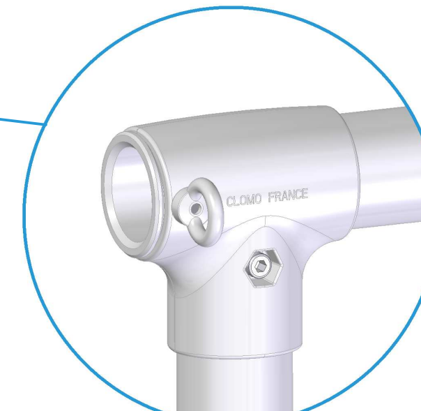
TE "SPECIAL" EN ZAMAK POUR PASSAGE COULISSANT AVEC : - 1 BAGUE EN POLYAMIDE - 1 ANNEAU DE FIXATION - SYSTEME ANTI-ROTATION - SERRAGE PAR VIS METRIQUE M10
