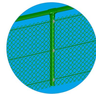
Poteaux et lisses en acier  $\varnothing 60 \times 2 \text{mm}$
