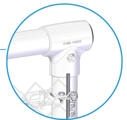
"TE" en zamak pour poteau de départ avec système anti-rotation. Serrage par vis métrique M10.
