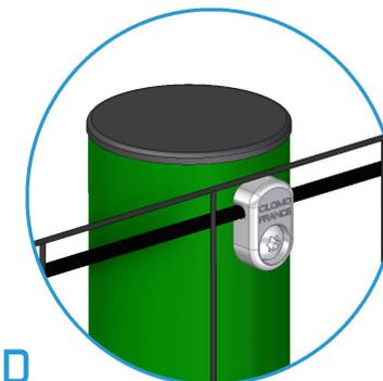
**D** **Guide câble zamak "CLOMO PRO"**, fixé mécaniquement sur le poteau à l'aide d'une vis torx M8.
