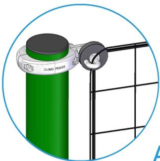
**A** **Poulie en polyamide** Ø62mm, avec crochet de maintien inox pour le filé. Fixée sur le poteau à l'aide d'une bride zamak.
