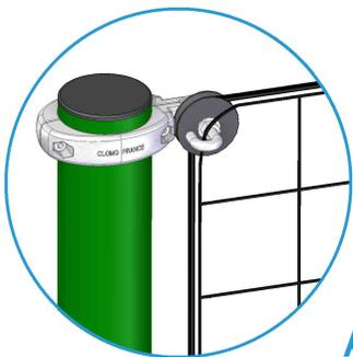
**Poulie en polyamide**  $\varnothing 62$ mm, avec crochet de maintien inox pour le filet. Fixée sur le poteau à l'aide d'une bride en zamak.
